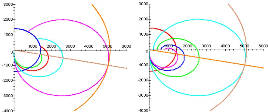
Le petit demi-cercle est le lieu des points où l'amplitude et la pulsation sont indépendantes de la résistance de la bobine. Sur le diagramme de gauche on a supprimé les parties des courbes pour  $\omega \in [0; 1/\sqrt{2LC}]$ .
